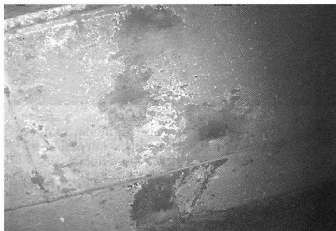
Следы попаданий снарядов на борту "Сиднея". Бортовая броня не пробита, но видна высокая точность стрельбы немцев
