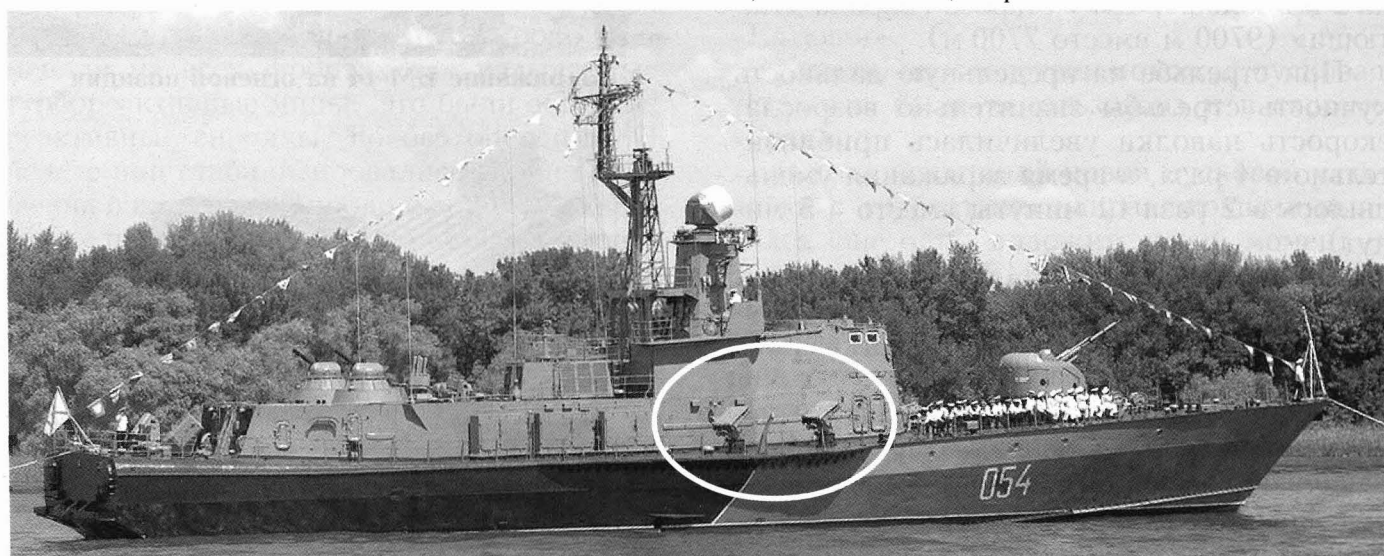
Пусковые установки БМ-14 (по две на борт) на современном малом артиллерийском катере
