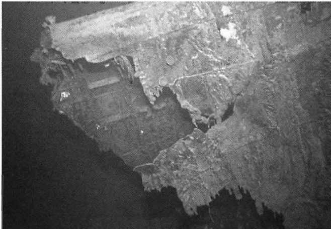
Оторванная носовая часть "Сиднея" в месте попадания торпеды. Взрыв торпеды, скорее всего, вызвал пожар носовых погребов и последующую гибель крейсера
