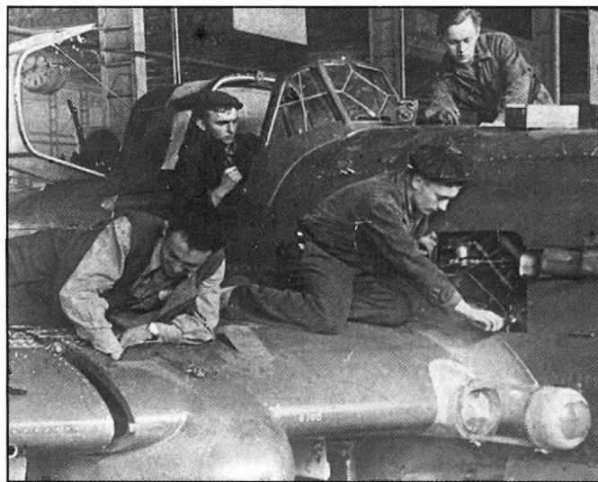
Сборка Ил-2 на заводе. Обратите внимание на остекление фонаря кабины пилота. В его переплете стояло специальное авиационное бронестекло толщиной 55 мм
